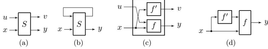
Fig. 4: (a) MPT  $S$ , (b)  $\text{feedback}(S)$ , (c) decomposable  $S$ , (d) feedback of (c).
