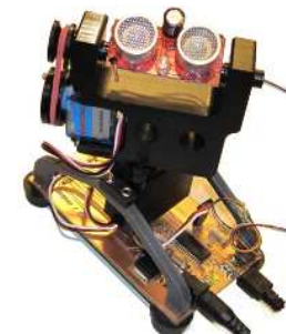
Figure 25: Problem 318: Teemu Jaakkolan rakentama ultraäänitutka
